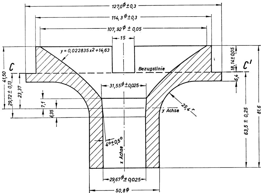
Die Bezugslinienlehre, die zur Bestimmung der Bezugslinie C-C' verwendet wird, gibt außerdem am Bildröhrehals und Konusübergang die innere Mantelfläche der Ablenkspule an. Da die Konusform oberhalb der Bezugslinie verschieden sein kann, empfiehlt es sich, die Spule nicht mehr als  $18,14 \pm 0,05$  mm über die Bezugslinie hinausragen zu lassen.
