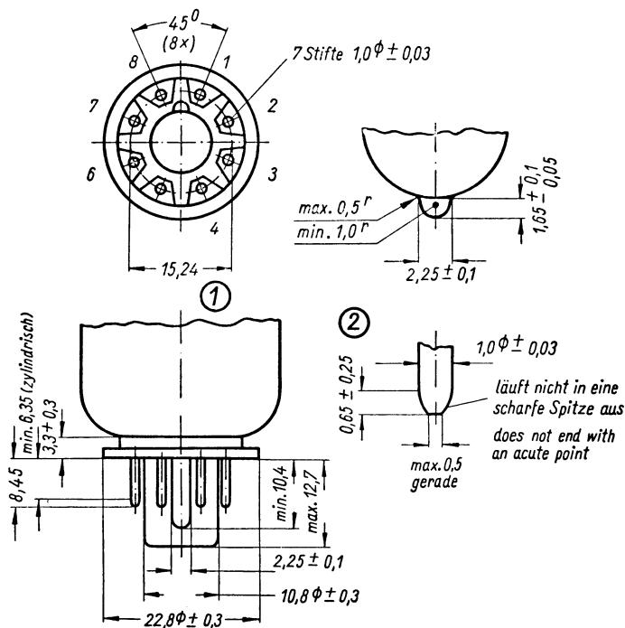
① Die Stifte sind so angeordnet, daß eine flache Lehre von 9,5 mm Dicke und 8 Löchern mit Durchmesser von  $1,40 \pm 0,01$  mm, die gleichmäßig auf einem Kreis von  $15,24 \pm 0,01$  mm angeordnet sind, leicht aufgesetzt und abgezogen werden kann.
