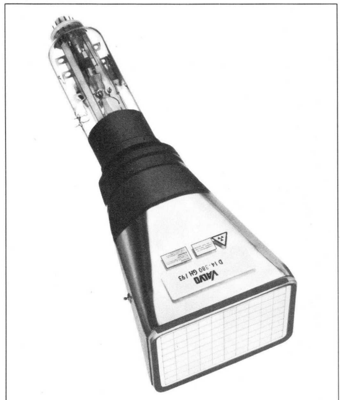
Bild 1. Die Röhre D 14-380 GH/93 als Beispiel für die neue Röhrengeneration
