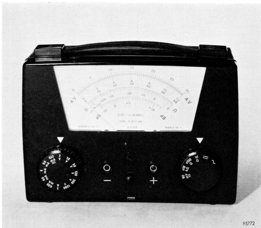
Foto 30. Universeel meetinstrument voor spanning, stroom en weerstand.
