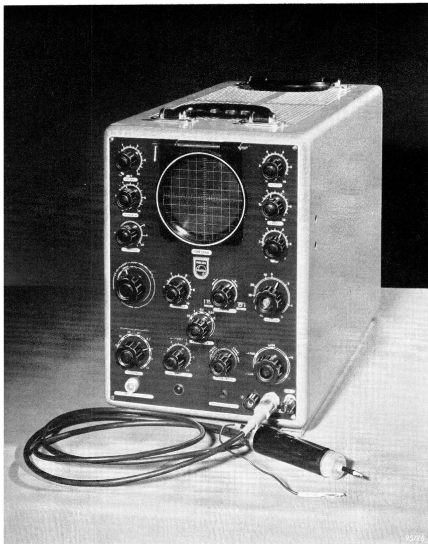
Foto 33. Kathodestraal-oscillograaf voor industriële doeleinden.
