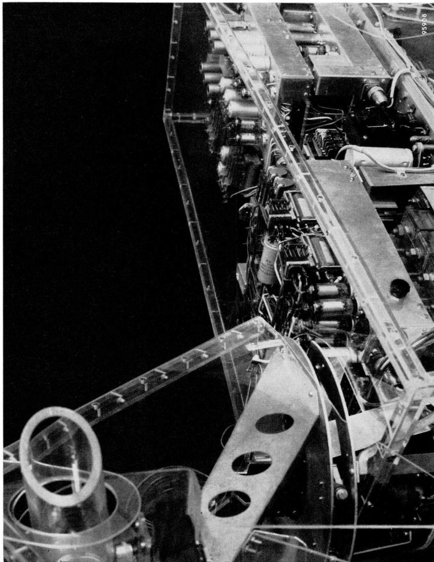
*Der Rumpf des Robotertieres von oben gesehen. Im Vordergrund das „Gehirn“ Chassis mit darunterliegendem Speiseakku. Dahinter der Zerhacker mit dem Zerhackertransformator und weiter die beiden Chassis für die „stereoskopischen“ und stereophonischen Schaltungen (oben) und das Radarchassis (unten). Im Vordergrund links ist die Drehkonstruktion des Halses zum Teil sichtbar.*
