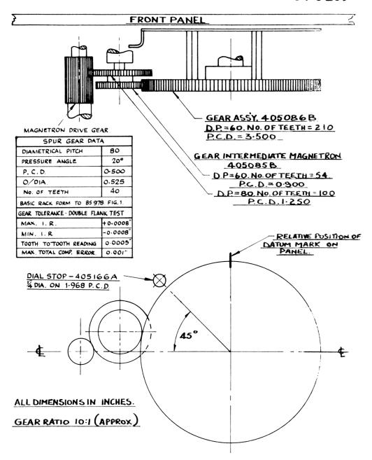
GEAR DRIVE TO MAGNETRON.
