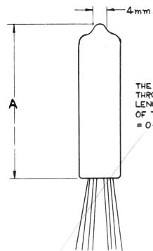
BULB STRAIGHTNESS TEST
