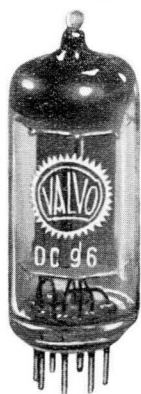
Abb. 1 III Die UKW-Mischtriode DC 96
