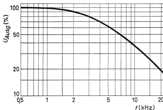
Abb. 48 III Grenzkurve für die Korrektur des Gesamt-Frequenzganges bei Mikrofonie
