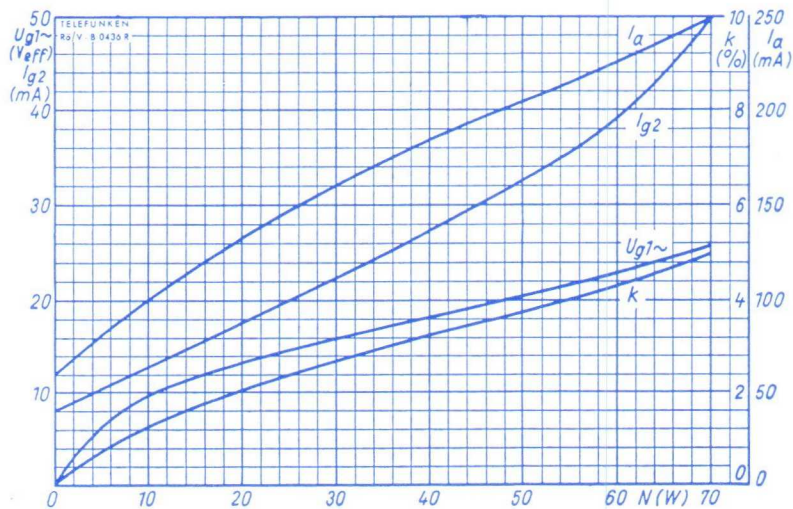
2 Röhren in Gegentakt-B-Betrieb • 2 tubes push-pull, class B
