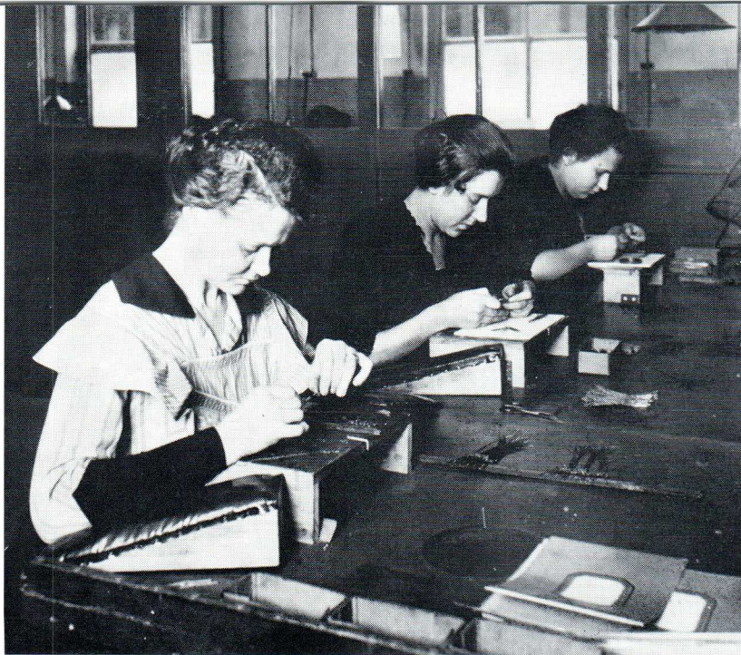
Röhrenfertigung im Jahre 1920: Handfertigung von Elektrodenzuleitungen
