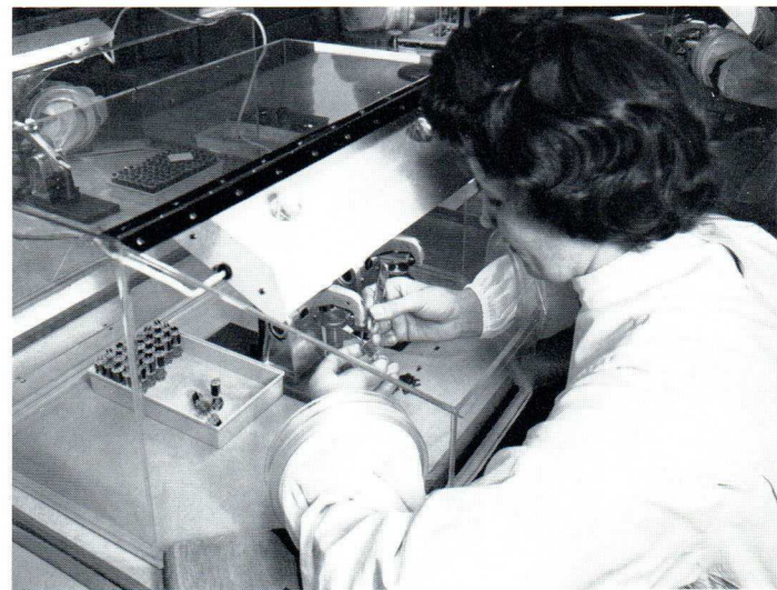
Schweißen der Elektrodensysteme an staubfreien Arbeitsplätzen
