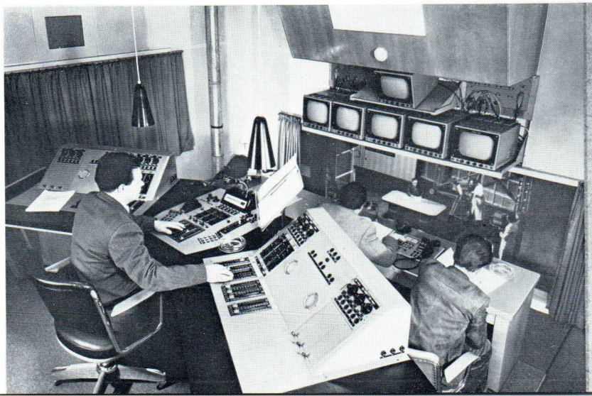
Ein Bild- und Tonregieraum in einem Fernsehstudio. Allein das Tonmischpult enthält 52 Röhren
