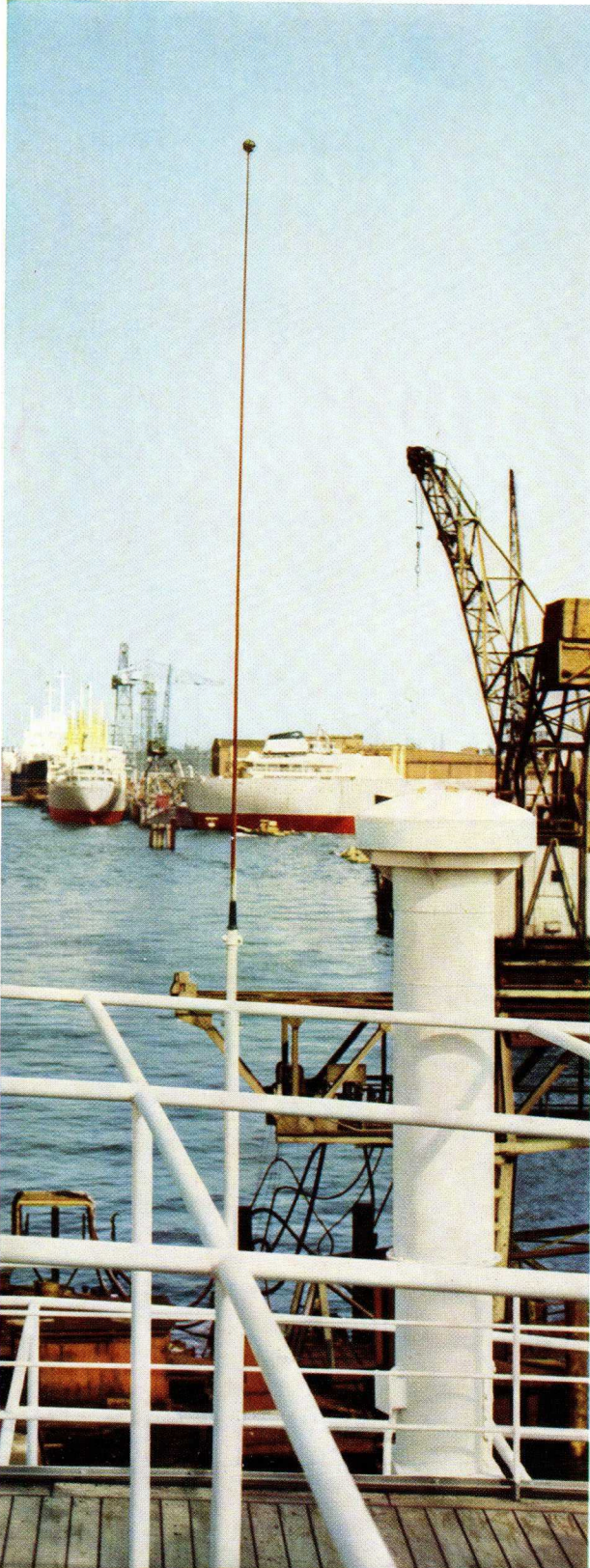
Schiffsgemeinschaftsantenne für den Rundfunkempfang
