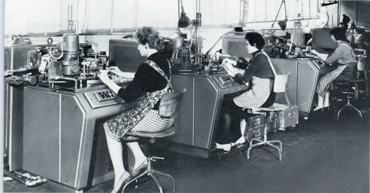
Hartlöten von Kontakten in Drehtellerautomaten, die von 5-kW-HF-Generatoren gespeist werden.
