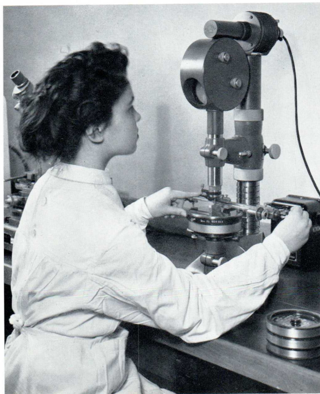
Für die Heizer und Gitter bestimmte Feindrähte (0,006 bis 0,10 mm \phi ) werden auf ihre Rundheit geprüft
