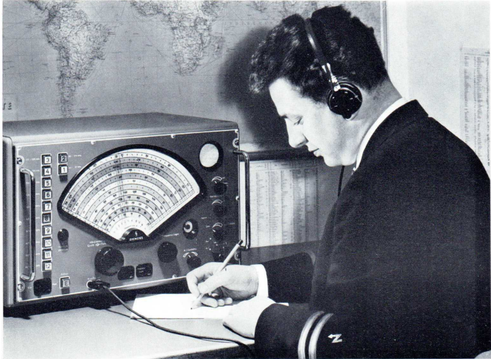
Allwellenempfänger in der Funkkabine eines Überseeschiffes
