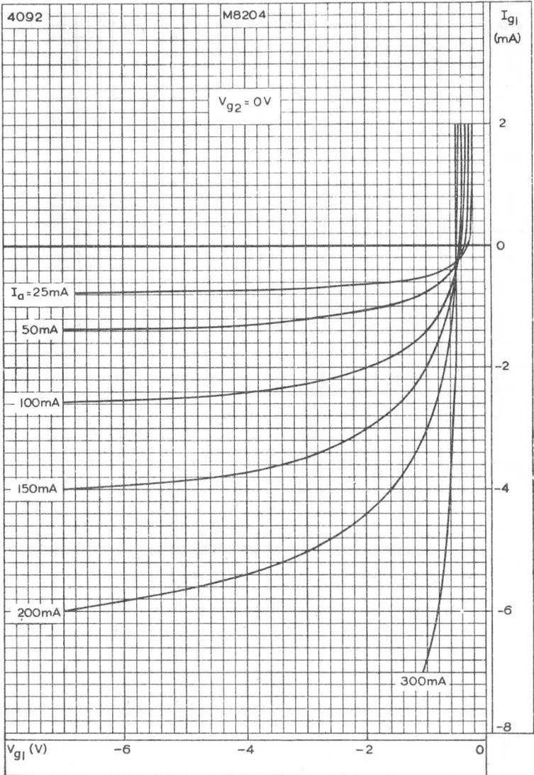
CONTROL-GRID CURRENT PLOTTED AGAINST CONTROL-GRID VOLTAGE
