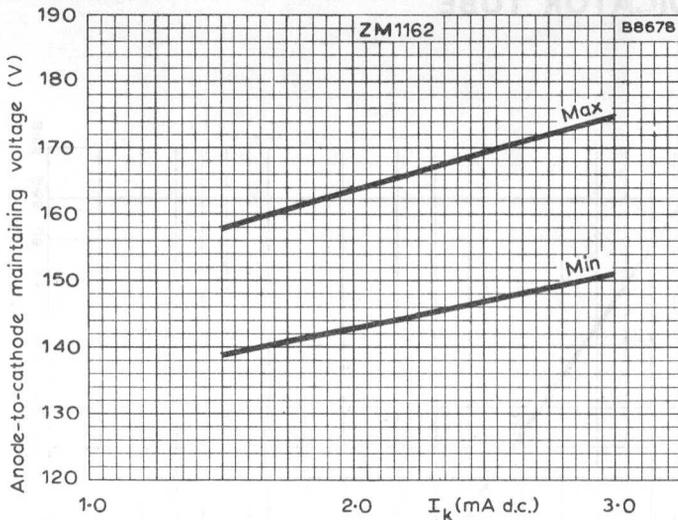
ANODE-TO-CATHODE MAINTAINING VOLTAGE
