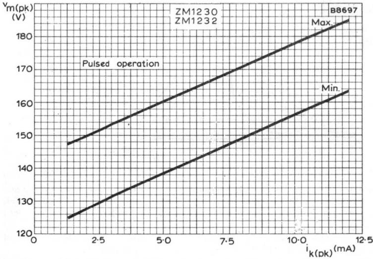
PEAK ANODE-TO-CATHODE MAINTAINING VOLTAGE
