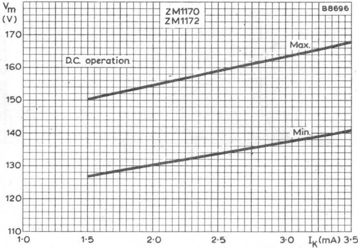
ANODE-TO-CATHODE MAINTAINING VOLTAGE
