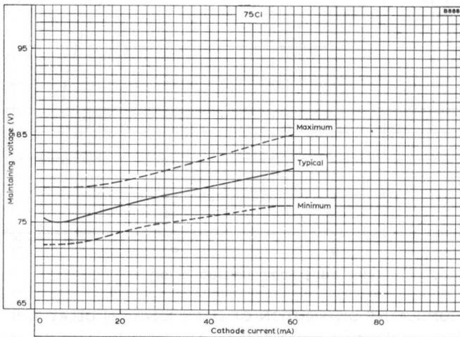
MAINTAINING VOLTAGE PLOTTED AGAINST CATHODE CURRENT
