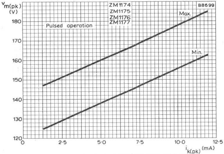
PEAK ANODE-TO-CATHODE MAINTAINING VOLTAGE
