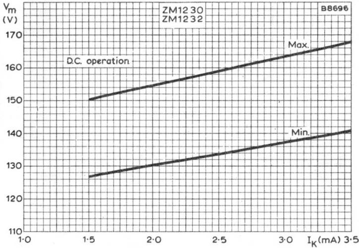
ANODE-TO-CATHODE MAINTAINING VOLTAGE
