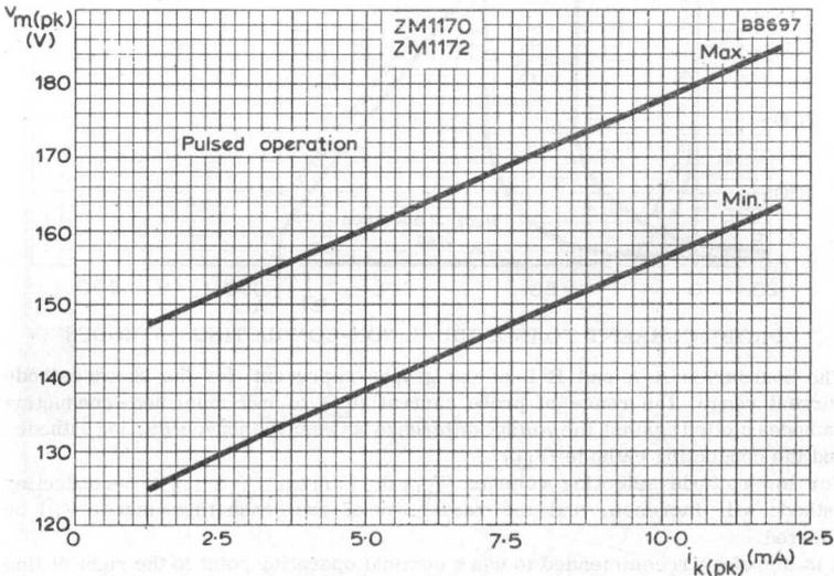
PEAK ANODE-TO-CATHODE MAINTAINING VOLTAGE
