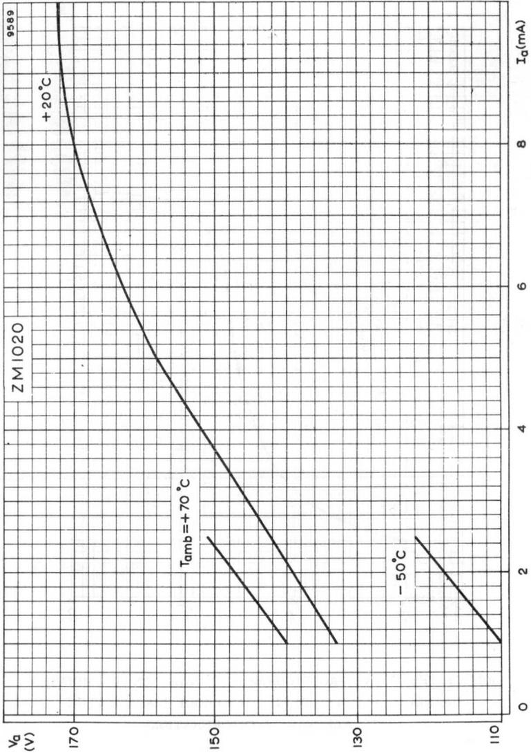
NOMINAL ANODE-TO-CATHODE MAINTAINING VOLTAGE
