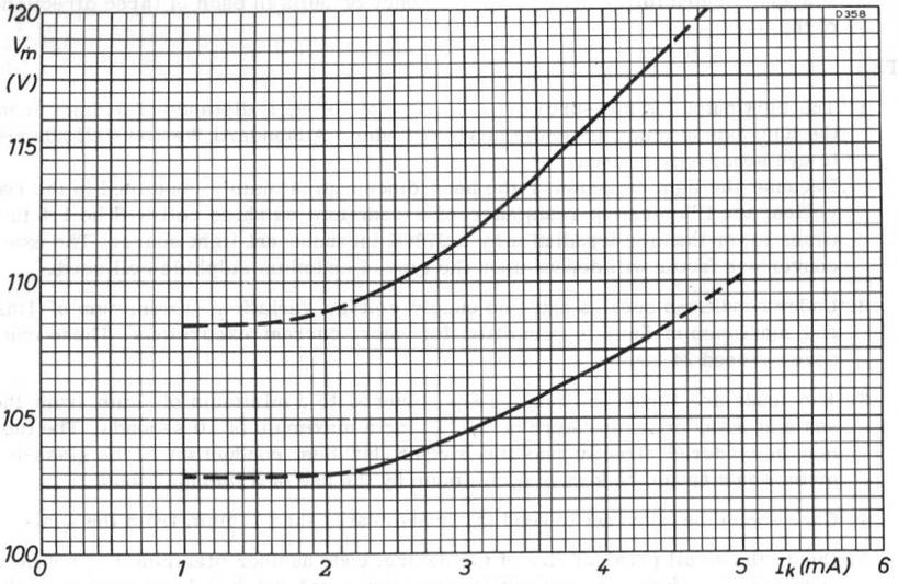
ANODE-TO-CATHODE MAINTAINING VOLTAGE
