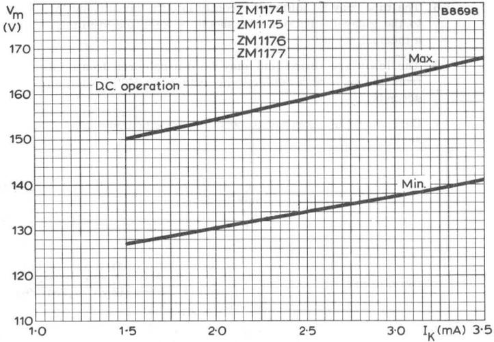
ANODE-TO-CATHODE MAINTAINING VOLTAGE
