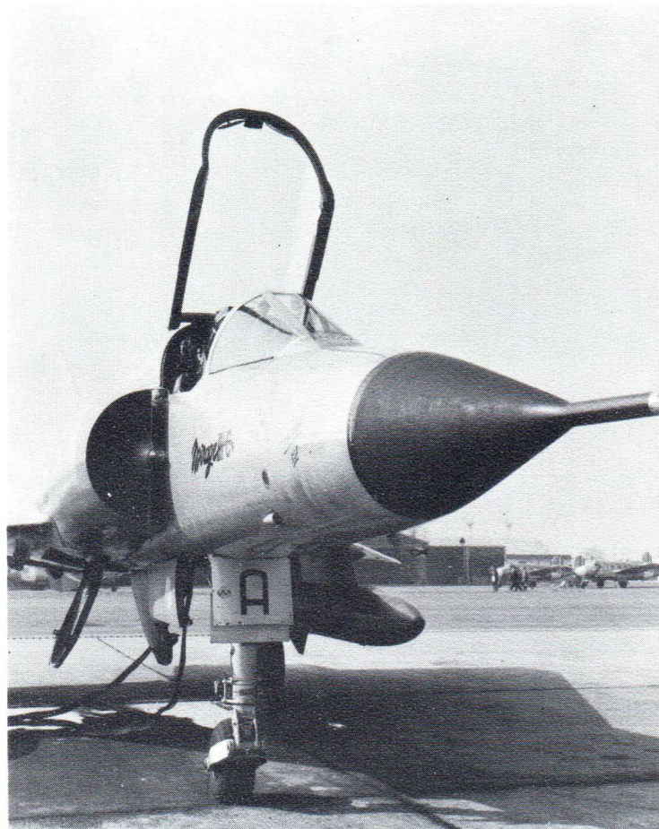
Le radar "Cyrano" monté sur avion "Mirage III" est équipé d'un tube à entretien d'image CSF.
