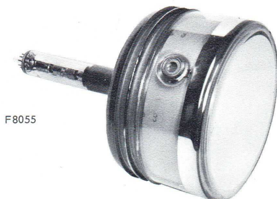
Le radar "Cyrano" monté sur avion "Mirage III" est équipé d'un tube à entretien d'image CSF.
