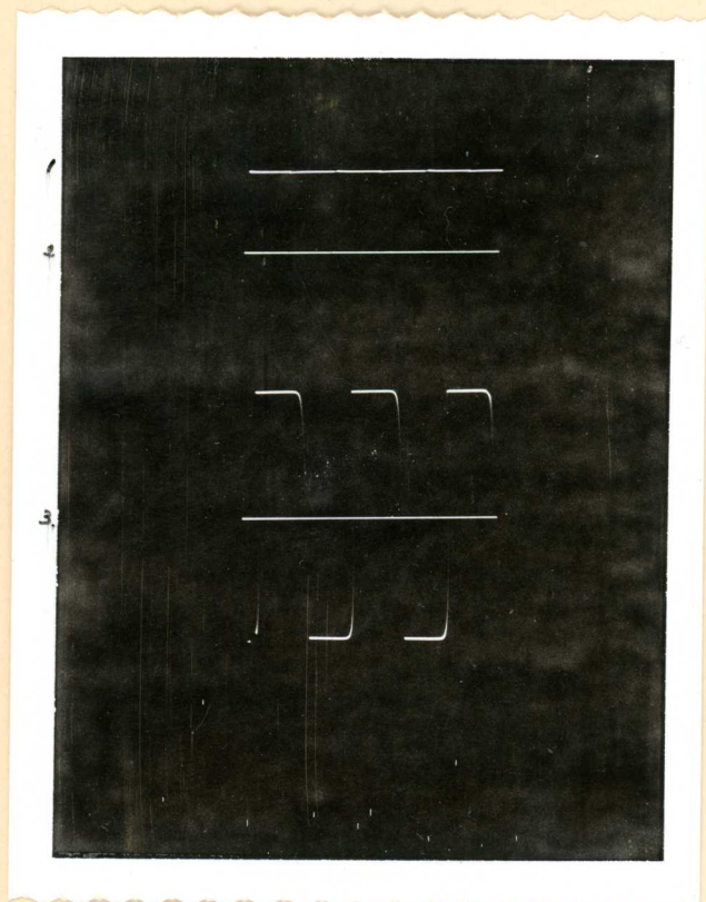
Buis met y-afscherming. Y_1 " en Y_2 " geaard via 100 k \Omega
